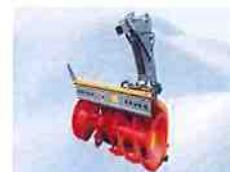
Pour l'agrégat fraise nous avons choisi la SF 72-70-160 KS de la marque Zaugg. Notre fraiseuse 1400 est équipée d'un modèle de ce constructeur, qui a une renommée mondiale dans ce genre d'agrégat. Le service après-vente est de qualité. De plus si besoin, nous pourrions utiliser la cheminée de chargement équipant notre fraiseuse actuelle sur le nouveau véhicule.
